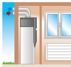
**INSTALLATION DANS UNE PIÈCE CHAUFFÉE DE SURFACE QUELCONQUE, HAUTEUR SOUS PLAFOND ≥ 2,30 m POUR 220 L ET ≥ 2,10 m pour 270 L**
