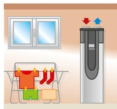
**INSTALLATION DANS UNE PIÈCE HORS GEL, VOLUME ≥ 20 m<sup>3</sup> (HORS ENCOMBRANTS), HAUTEUR SOUS PLAFOND ≥ 2,10 m POUR 270 L ET ≥ 1,90 m pour 220 L**
